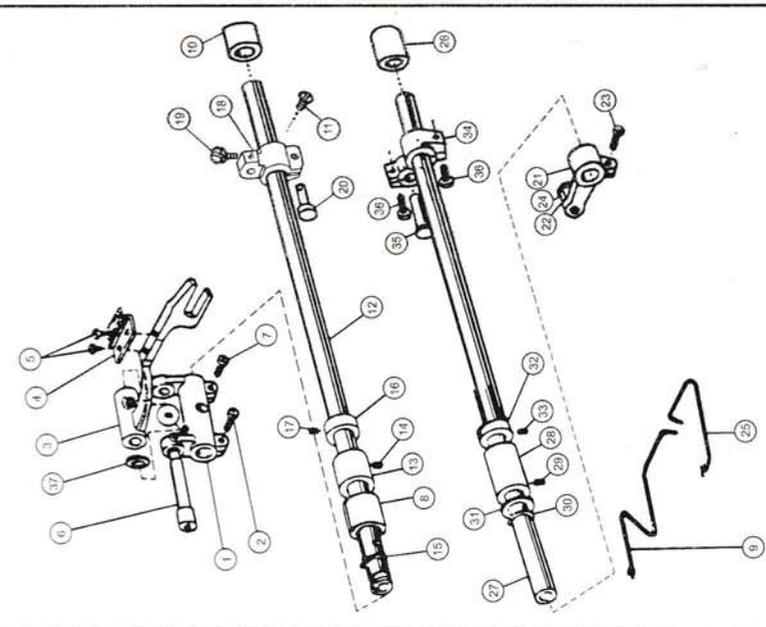
4. 送布部件 / Feed Mechanism Components
