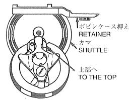
ボビンケースをカマに装着する。(軽く押し上げる感じ) PUSH IN AND UPWARDS INTO SHUTTLE
